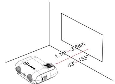
La distance entre l'Apollo P20 et la surface de projection doit être au minimum de 1,1 mètre (35 pouces) et au maximum de 3,88 mètres (120 pouces).
